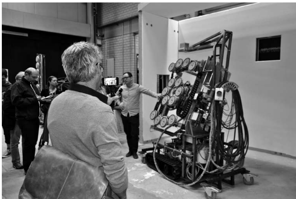
Karlsruher Technisches Institut: Wird ein AKW stillgelegt, muss grossflächig dekontaminiert werden, was bisher unter grossem Risiko von Menschenhand erfolgte. Das Institut entwickelt Roboter, welche diese Arbeiten den Menschen abnehmen können. Die Prototypen funktionieren. Es braucht aber Geld und Investoren. Fotos: Andreas Nidecker
